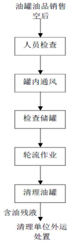
图 2-10 油罐清理流程图
