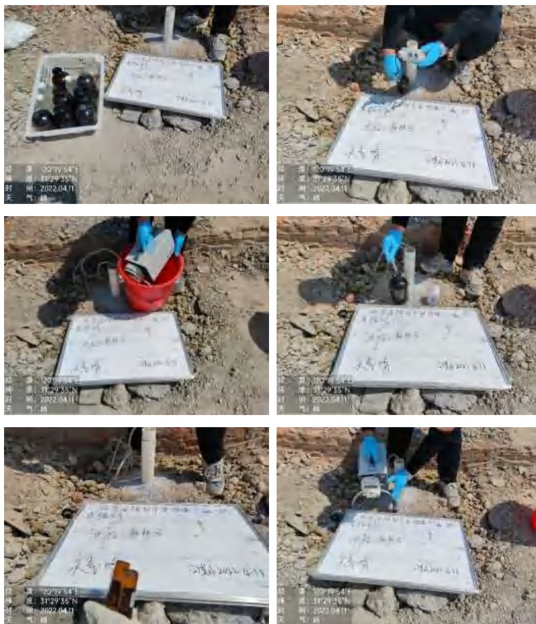
图 4.2-9 地下水采样洗井
