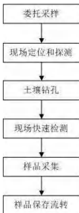
图 4.2-1 土壤采样工作流程示意图
