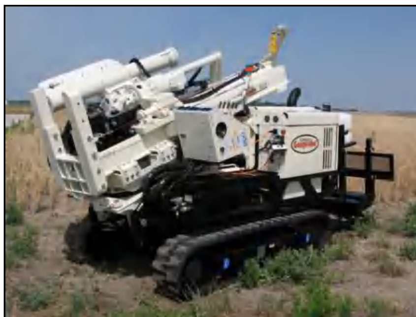
图 5.1-2 Geoprobe 7822DT 型土壤地下水取样修复一体钻机
