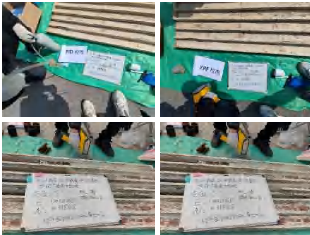
图 5.1-4 现场 XRF、PID 校准及使用
